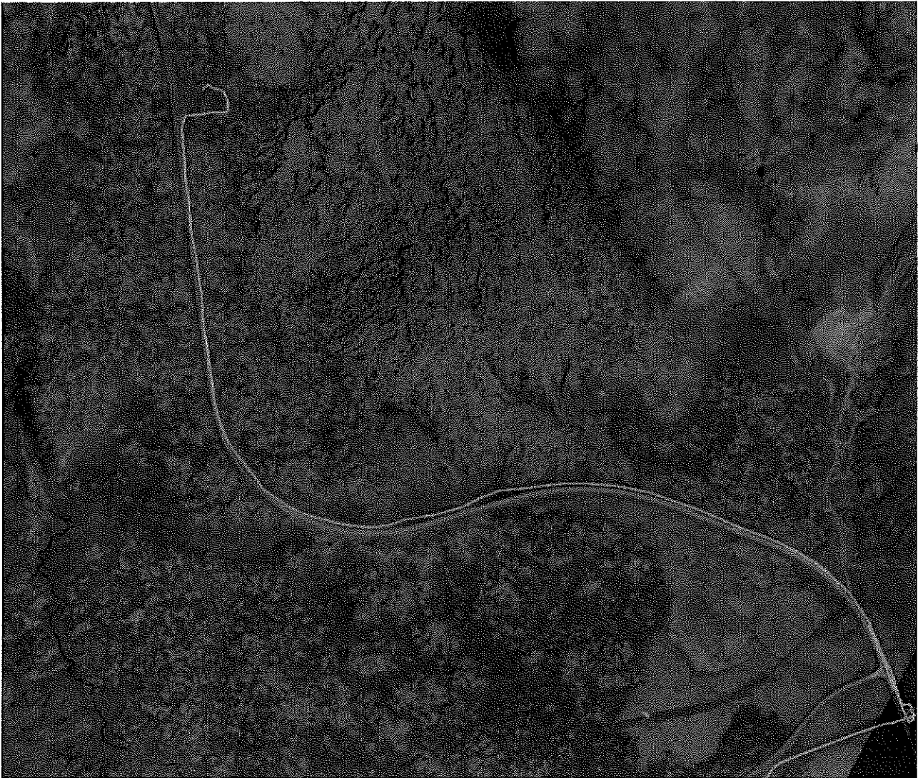
MYND 2 Rafstrengurinn í Raufarhólshelli liggur í vegöxl Þrengslavegar. Viðbót alla leið í Litla-Sandfell mun fylgja veginum alla leið. Mynd: Kortasjá Rarik
